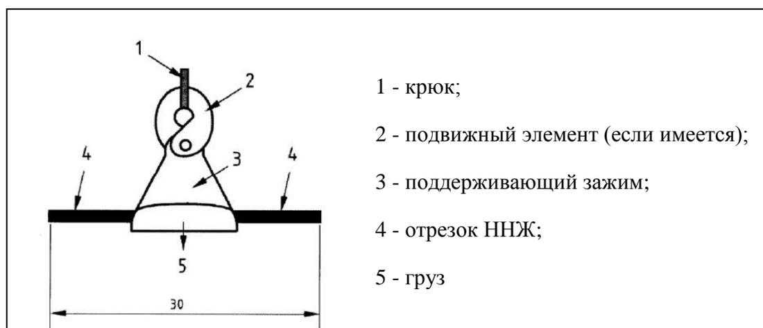
Рисунок 7.12 – Схема испытаний на коррозионную стойкость
